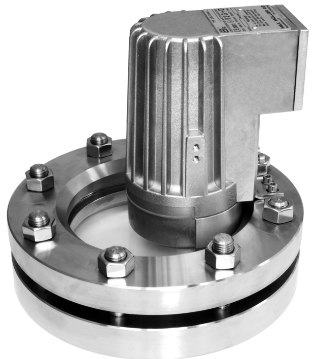
Typ HEL 50 deHW, Ex d e IIC T3 Gb, Ex t IIIC T195°C Db / IP67, Ex II 2 G + D, 230 V, 50 W, Halogenausführung, auf Schauglasarmatur nach DIN 28120, DN 125, PN 10. Einsatz als Anordnung «Licht- und Sichtglas».
